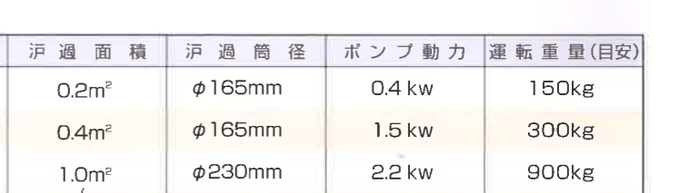
★FAタイプ スラッジタンクへ自動排出します。
